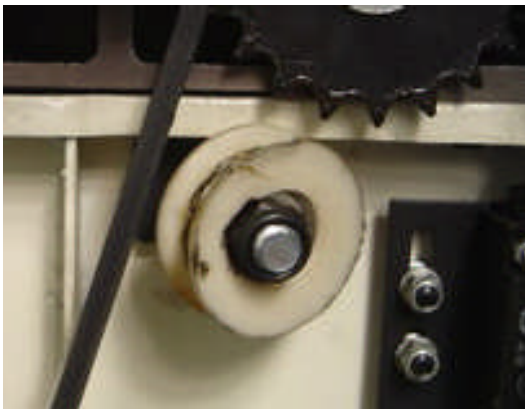
Bent shaft, damaged idle roller (often) Achse der Spannrolle verbogen, Rolle beschädigt (oft)
