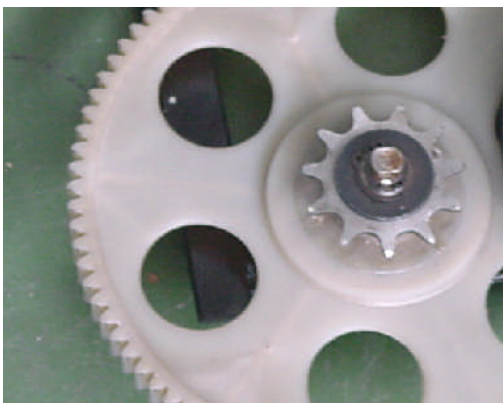
Teeth broken on plastic gear (seldom) Plastikzähne gebrochen (eher selten)
