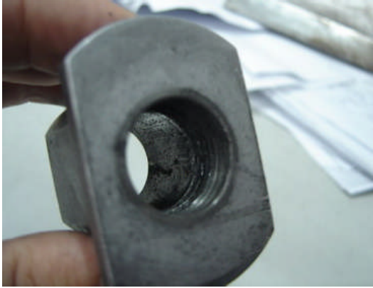
Powder steel bushing seized (always to be changed) Sinterlager verrieben (immer zu tauschen)
